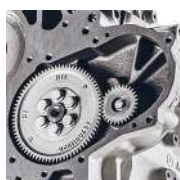
Eje comando de válvulas.
